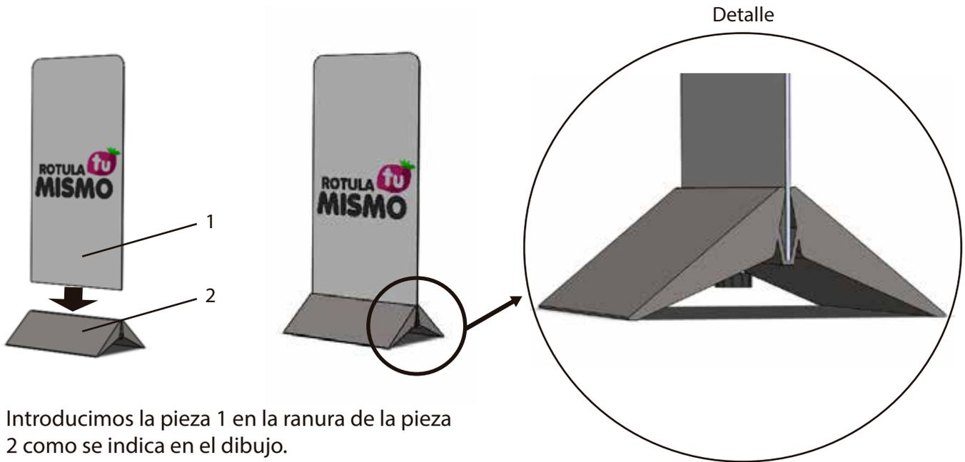
Introducimos la pieza 1 en la ranura de la pieza 2 como se indica en el dibujo.
